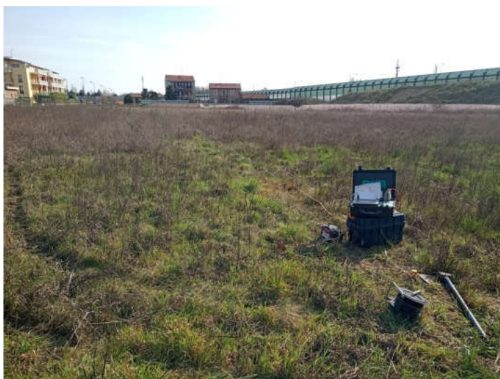
Posizionamento dell'attrezzatura geofisica MASW sul sito di interesse
