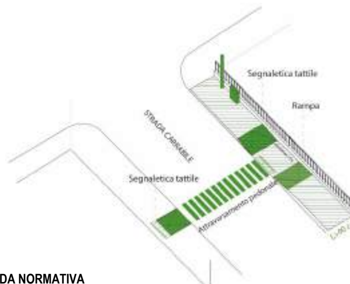
ZONA C - Punto C77- C78 - Via Don Giovanni Minzoni- Messa in piano marciapiede + segnalazione percorso protetto
