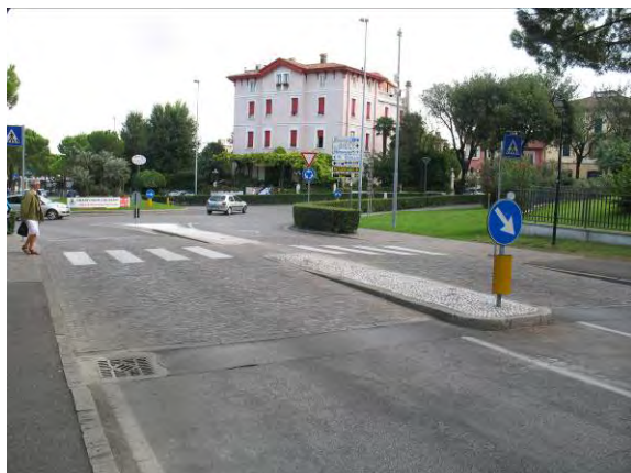
Esempio di attraversamento pedonale rialzato
