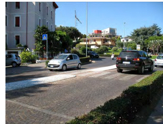
esempio di attraversamento pedonale rialzato
