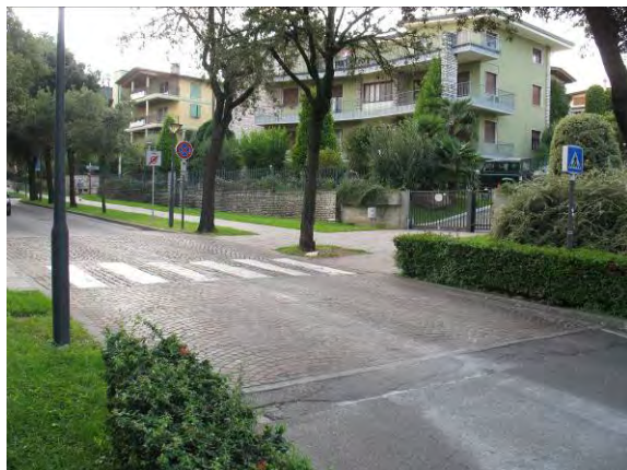
Esempio di attraversamento pedonale rialzato
