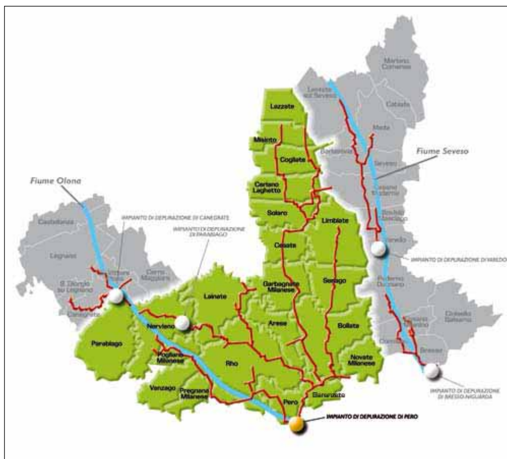
Schema dei collettori recapitanti al depuratore di Pero (fonte:lanomi spa)
